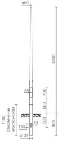
Анодирование: 10 цветов, каждый с возможностью глянца Материал: шлифованный, анодированный алюминий, с дополнительной возможностью обеспечения эластомером по цвету опоры до высоты 350 мм (другая высота по желанию клиента)
